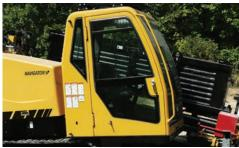
MEHR KOMFORT. Zusätzlichen Komfort bietet die Klimaanlage der wetterfesten Kabine sowie ein reduzierter Geräuschpegel von nur 80 dB(a) am Ohr des Bedieners.
