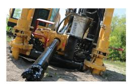
WENIGER EINSCHRÄNKUNGEN. Da der Bentonitfluss durch die Innen- und Außenstange geleitet wird, ergeben sich mehr Möglichkeiten bei der Werkzeugwahl. Somit steht mehr Spülungs- oder Luftvolumen für den Einsatz mittels Felsbohrkopf, Lufthammer oder Aufweitwerkzeug zur Verfügung.
