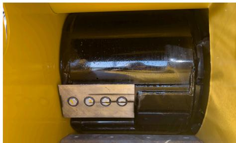
**TAMBOUR DE BROYAGE.** Le broyeur de branches Vermeer BC1000XL utilise un tambour équilibré avec précision et deux coupeaux A8 à double face pour broyer des végétaux d'un diamètre allant jusqu'à 30 cm.
