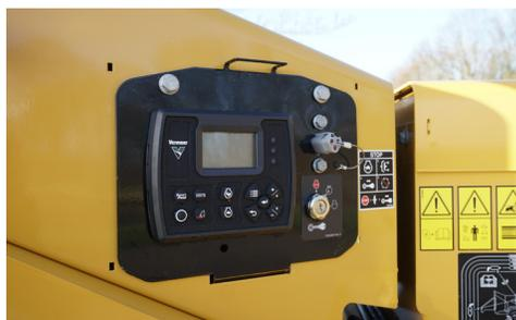
**SYSTÈME DE CONTRÔLE DU MOTEUR ECOIDLE™.** Lorsque le système Ecolidle est sélectionné par l'opérateur, le régime moteur descend automatiquement à un niveau prédéfini après une à cinq minutes d'inactivité, afin de réduire la consommation de carburant lorsque la machine est inactive. Cette marche au ralenti permet de réduire les émissions et le bruit.
