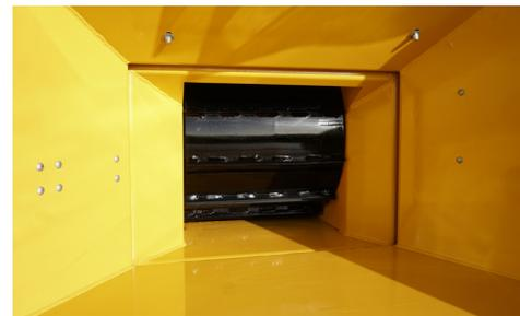
**ROULEAU AMENEUR.** Une grande ouverture d'alimentation (44 cm x 30 cm) permet d'augmenter la productivité en réduisant la nécessité de couper les végétaux avant de l'introduire dans le broyeur.
