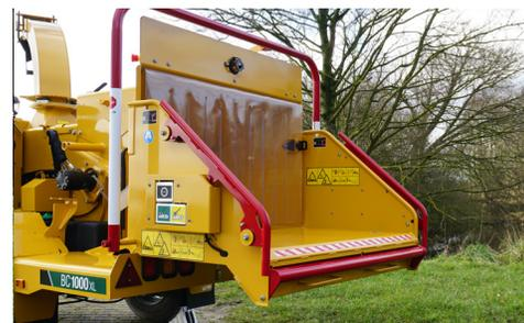
**SMARTFEED.** Le système SmartFeed surveille le régime du moteur et arrête ou inverse automatiquement le rouleau d'alimentation pour maximiser la productivité. Ce système détecte également les bourrages du rouleau d'alimentation et manipule le matériau automatiquement pour réduire l'utilisation de la barre de commande manuelle.
