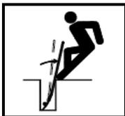
**ПРЕДУПРЕЖДЕНИЕ.** Удар направляющим инструментом может причинить тяжелые травмы и даже привести к смертельному исходу. Категорически запрещается «помогать» буровой установке руками, ногами, лопатой, граблями и прочими инструментами.
