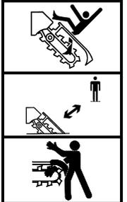
**ОПАСНО.** Прикосновение к движущейся землеройной цепи может привести к несчастному случаю или серьезным травмам. Обрушение стенок траншеи может стать причиной падения человека на работающую цепь.
