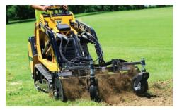
**LEISTUNGSSTARK.** Eine maximale Kipplast von 1198,9 kg sowie einer Einsatzkapazität nach SEA-Norm von 419,6 kg sorgen für eine hohe Leistung selbst bei schwierigsten Bodenbedingungen. Der S925TX erreicht eine maximale Abladehöhe von 217,7 cm.
