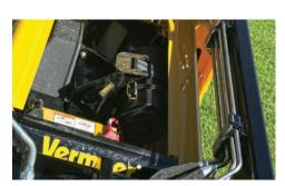
LEICHTER ZUGANG ZU SERVICEPUNKTEN. Tägliche Servicepunkte sowie Wartungsbereiche sind durch die übersichtliche Bauweise selbst ohne Werkzeug zugänglich.
