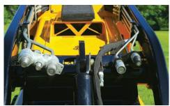
HYDRAULIK. Serienmäßig ist der S925TX Kompaktlader mit einem Dual-Hydrauliksystem ausgestattet und bringt mit einer Durchflussmenge von 45,4 L/min bzw. 58,7 L/min eine starke Leistung auf eine Vielzahl von Anbaugeräten.
