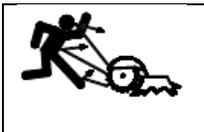
**ADVERTÊNCIA:** Objetos lançados pela roda cortadora girando podem ferir o operador.
