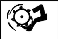
**PERIGO:** Entrar em contato com a roda cortadora irá resultar em ferimentos graves, desmembramento ou morte.
