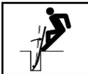
**ADVERTENCIA:** Si resulta golpeado por una herramienta guía podría sufrir lesiones graves o la muerte. No use nunca las manos, los pies, palas, rastrillos u otras herramientas para asistir en la conexión manual del accesorio de perforación.
