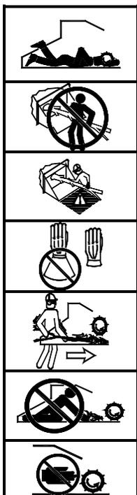
**ОПАСНО.** Ветки могут захватить одежду. Валики или лезвия могут захватить и втянуть конечность машиниста быстрее, чем он сможет ее отдернуть. Попадание частей тела в режущий инструмент может привести к серьезной травме или смертельному исходу.
