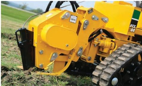
**MAXIMALE PRODUKTIVITÄT.** Zur Installation von Bewässerungs- und Versorgungsanlagen ist die vielseitige PTX44 Pflug/ Fräse mit einer Pflugtiefe von bis zu 61 cm, einer Frästiefe von bis zu 106,7 cm und einer Fräsbreite von 15,2 cm ausgestattet.
