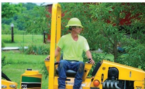
**ÜBERSICHTLICH.** Der Bedienstand befindet sich direkt über dem Knickgelenk der Maschine und bietet dem Bediener hervorragende Sicht auf das Arbeitsumfeld.
