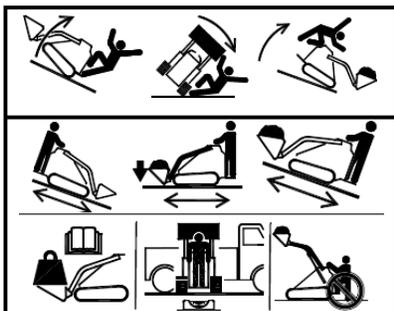
**AVISO:** A condução em encostas ou com a carga elevada pode resultar num capotamento. O esmagamento causado pela máquina por resultar em ferimentos graves ou fatais.
