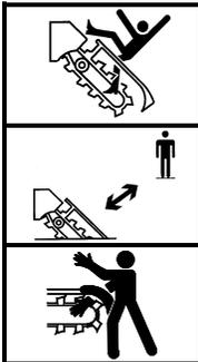
**DANGER** : le contact avec la chaîne trancheuse en mouvement provoque des blessures graves ou mortelles. L'effondrement de la tranchée risque de faire tomber l'opérateur de la machine sur la chaîne en mouvement.
