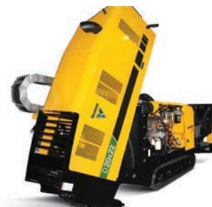
**LEICHTE WARTUNG.** Die hochklappbare Metallhaube der Bohrmaschine, bietet einfachen Zugang bei routinemäßigen Service- und Wartungsarbeiten.
