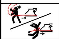
**GEFAHR:** Die Häckslermesser können das Seil und die daran hängende Last erfassen und mit hoher Geschwindigkeit in die Maschine ziehen. Wenn eine Person von der Maschine getroffen, erfasst oder in diese hineingezogen wird, besteht die Gefahr schwerer oder tödlicher Verletzungen.
