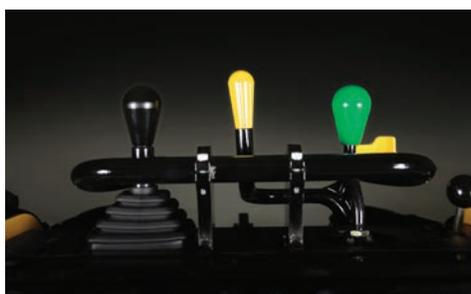
**BEDIENERKOMFORT.** Die Joystick-Steuerung des Fahrtriebs bietet gegenüber einer Bedienung mit zwei Hebeln mehr Komfort und einfacheres Handling.
