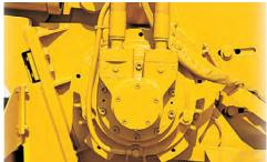
ROTARY POWER TRENCHER DRIVE MOTOR.
