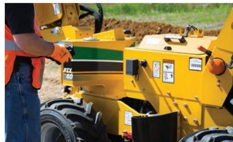
**FERNBEDIENUNG.** Zum Pflügen oder auch für den Transport ist man durch die Fernbedienung besonders in beengten Verhältnissen ideal ausgestattet. Sie liefert eine präzise und ruhige Steuerung und bietet dem Bediener stets freie Sicht auf den Arbeitsbereich. Nur zum Grabenfräsen muss aus Sicherheitsgründen die Funksteuerung mittels Kabel an der Maschine verbunden werden.
