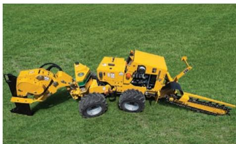
**KNICKGELENKAUSFÜHRUNG.** Eine Knickgelenkausführung bietet eine verbesserte Manövrierbarkeit in beengten Räumen und eine außerordentliche Leistung unter Maximierung der Zugkraft bei Betrieb in unebenem Gelände.
