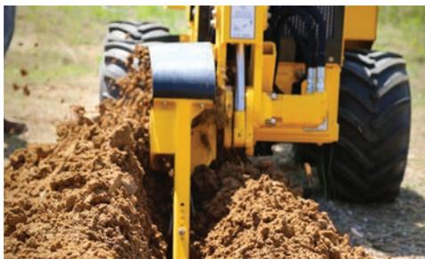
**MASCHINENVIELSEITIGKEIT.** Zur Installation von Bewässerungs- und Versorgungsanlagen ist die vielseitige PTX40 Pflug/ Fräse mit einer Pflugtiefe von bis zu 61 cm, einer Frästiefe von bis zu 106,7 cm und einer Fräsbreite von 10,2-15,2 cm ausgestattet. Der optionale Erdbohrer hat ein maximales Drehmoment von 840,6 Nm.
