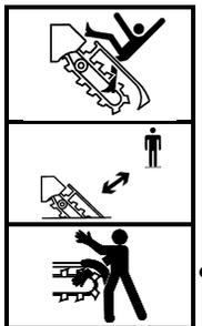
**PERIGO:** Entrar em contato com a corrente de escavação em movimento irá resultar em morte ou ferimentos graves. O desmoronamento da vala pode fazer você cair sobre a corrente em movimento.
