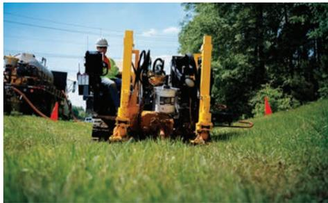
**WENN ES EINE AUFGABE ZU ERLEDIGEN GIBT.** Mit 124,6 kN Schub- und Rückzugskraft und 5694,4 Nm Drehmoment, bietet die D24x40 S3 eine Steigerung gegenüber seinem Vorgänger und trägt zur Maximierung der Maschinen- und Baustellenproduktivität bei.
