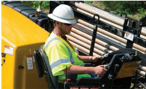
**BEDEUTENDE REDUZIERUNG DER GERÄUSCHENTWICKLUNG.** Mit einem garantierten Geräuschpegel von 104 dB(A) und einem Schalldruck am Ohr des Bedieners von 82,9 dB(A) sowie einem Geräuschpegel von 75,7 dB(A) in der Kabine, trägt die D24x40 S3 zu einer leiseren Arbeitsumgebung bei, schafft weniger Lärmbelästigung bei Anwohnern und sorgt für eine leichtere Kommunikation unter der Crew.
