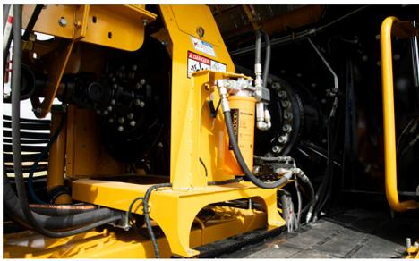
**TRANSMISSION MÉCANIQUE ET PROTECTION.** Équipé d'une transmission mécanique réversible pour un transfert de puissance efficace qui maximise la productivité. Un limiteur de couple débraye automatiquement l'entraînement lorsque le couple maximal est atteint, ce qui permet de protéger les composants critiques de la machine.
