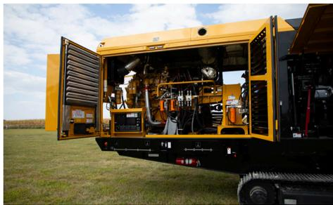
**ACCÈS AU COMPARTIMENT MOTEUR.** La LS3600TX offre un accès inégalé à la machine. La conception du compartiment moteur, facile à entretenir et très accessible, comprend de grandes portes d'accès, plusieurs points d'attaches pour l'échelle et une grande plate-forme pour faciliter l'entretien et la maintenance.
