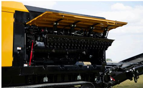
**ACCÈS COMPLET AU ROTOR.** La porte latérale à commande hydraulique permet d'accéder entièrement au rotor, au peigne et au convoyeur ventral pour minimiser le temps d'entretien. La zone d'entretien a été conçue pour vous permettre d'effectuer l'entretien sans obstacle en hauteur.
