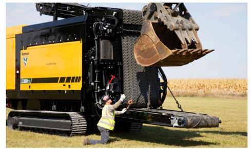
**ENTRETIEN DU CONVOYEUR VENTRAL.** Le convoyeur ventral peut être retiré sans détacher le convoyeur de décharge, ce qui permet un entretien peu invasif.
