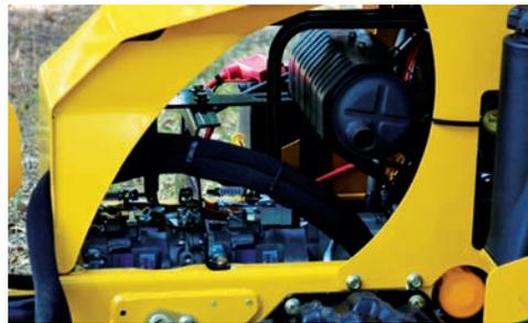
**MOTOR.** Der 19 kW (25 PS) Kohler Benzin Motor mit elektronischer Kraftstoffeinspritzung (EFI) überzeugt durch sein leichtgängiges Startverhalten, ist im Kraftstoffverbrauch sehr sparsam und stößt im Schnitt 25% weniger Abgase aus als herkömmliche Vergasermotoren.
