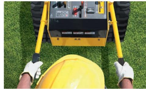
**VZ STEUERUNG.** Mit nur geringem Kraftaufwand lässt sich die Hebelsteuerung der RTX250 gegenüber traditionellen Lenkungen spielend leicht manövrieren und bietet dadurch selbst bei schwierigen Bodenverhältnissen volle Kontrolle.
