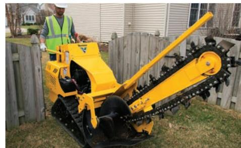
**SCHLANKES PROFIL.** Mit einer Breite von nur 87,6 cm kann die RTX250 auf engstem Raum eingesetzt werden und passt auch ideal durch Gartentore.
