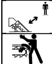
No se acerque a la cadena de excavación en movimiento.
