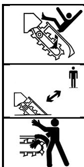
**PELIGRO:** El contacto con una cadena de excavación en movimiento causará lesiones graves o la muerte. Si se derrumba la zanja, usted podría caer sobre la cadena en movimiento.
