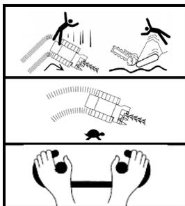
**ADVERTENCIA:** Los movimientos abruptos y la irregularidad del terreno pueden hacer que el operador se caiga de la máquina.
