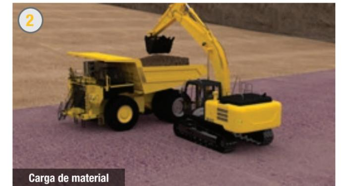
Los equipos de carga colocan el material en camiones de transporte para acarrearlo a lugares fuera de la mina.
